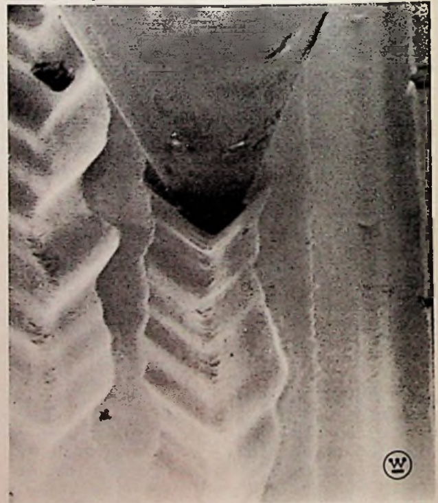
Afb. 1b. Duidelijk is te zien hoe de beide wanden van de stereogroef elk een eigen golfing bezitten als gevolg van de verschillende L- en R- signalen en dat de groefwanden een hoek van 90° met elkaar vormen.
