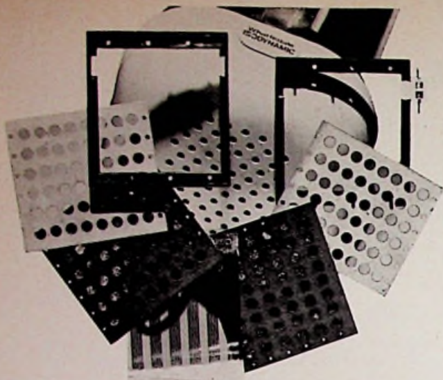
Uit bovenstaande delen is de hoofdtelefoon samengesteld.
