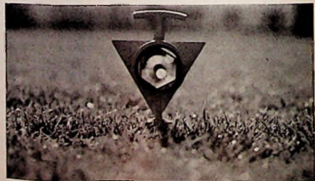
Links: Het score-bord met de door een computer berekende uitslagen. Onder: Prisma dat de infraroodbundel reflecteert.
